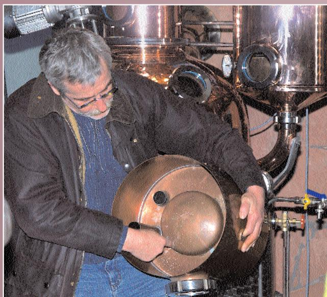
Interesse weckte die Fertigung der Brennanlagen. Im Bild wurde der Rauchgasabkühler an das Wasserbad geschweißt.
