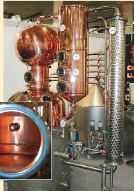
Der Umkehrkochboden (Detailansicht links) der Fa. Müller GmbH soll den Wirkungsgrad bei der Destillation wesentlich erhöhen und zartgliedrige aromaintensive Destillate liefern
