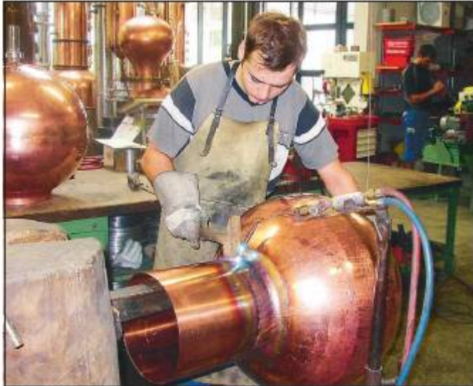
Feurig: Behälter- und Apparatebauer Daniel Kohler bei Schweißarbeiten am »Hut« der Brennanlage. Foto: Heinz Hättig
